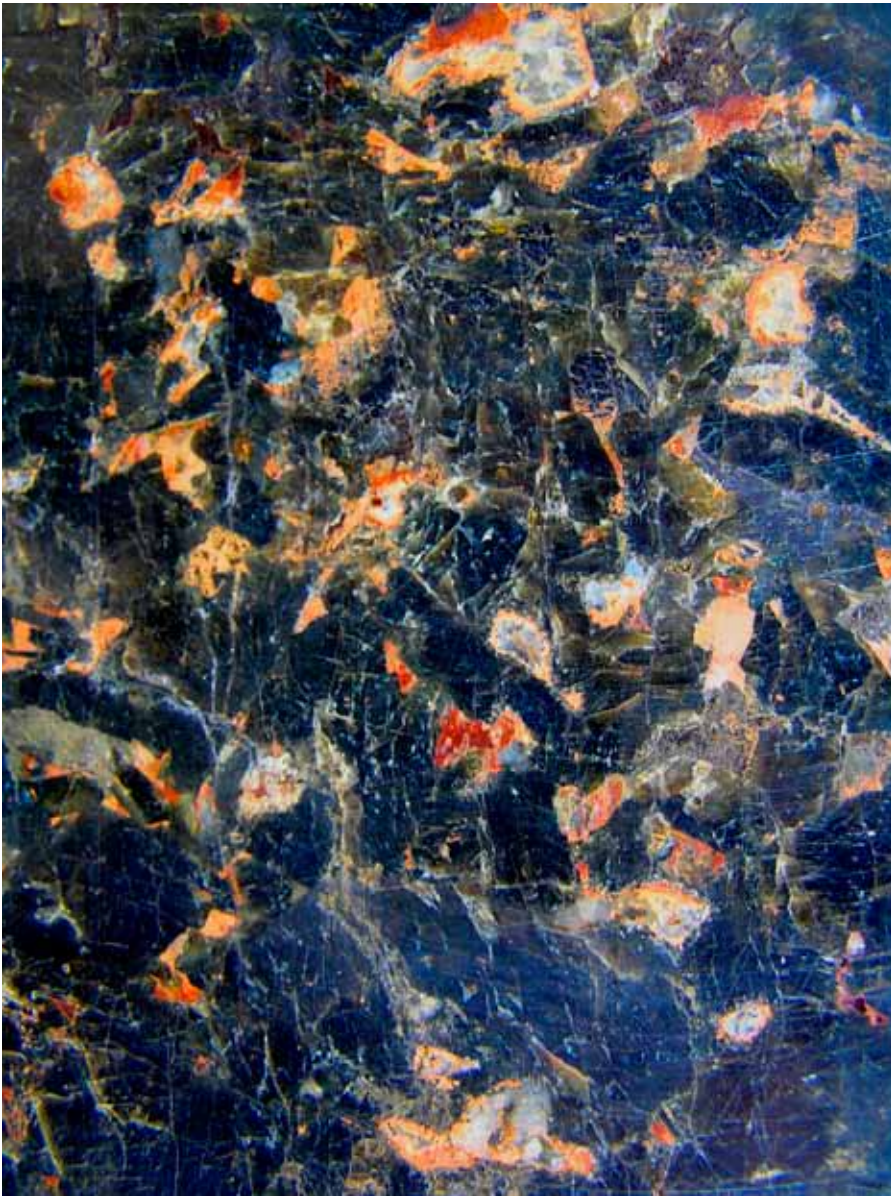
Рисунок 1. Мікрофотографія псевдоморфоз карбонатів та гідроксидів заліза по залізістим силікатам у лабрадоритовому облицюванні Будинку культури ім. Артема (м. Кривий Ріг)
