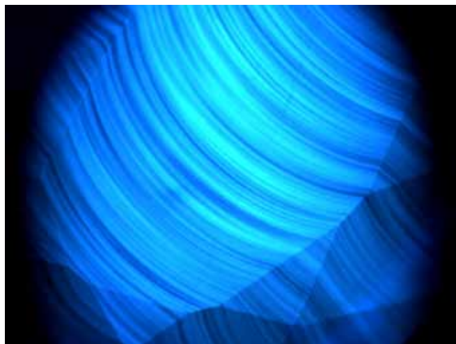
Рисунок 9. Структури росту в синтетичному сапфірі, вирощеного методом Вернейля
