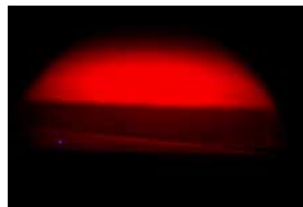
Рисунок 7. Флюоресценція в червоному або рожевому тонах у багатошаровому синтетичному смарагді
