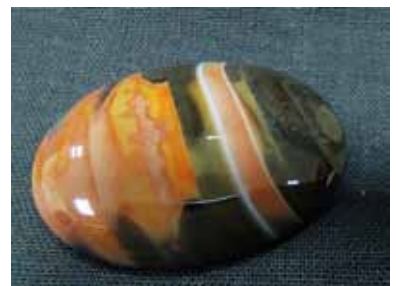
Рисунок 10. Агат, штучно пофарбований та термооброблений
