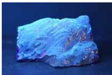
Рисунок 9. Флуоресценція зразка флюориту «Blue John» у короткохвильовому діапазоні
