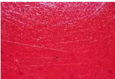
Рисунок 21. Подряпини поверхні, характерні для м'якої пластмаси
