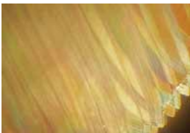
Рисунок 7. Двійникування в польовому шпаті (адулярі), поляризоване світло в імерсійному мікроскопі
