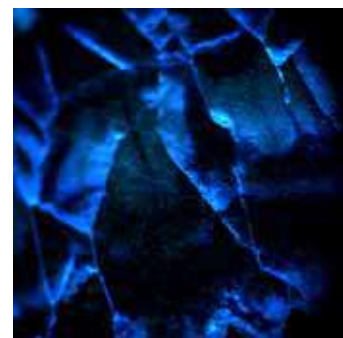
Рисунок 12. Світіння органічної речовини у тріщинках темно-фіолетового прошарку зразка флюориту «Blue John» у разі опромінення УФ-хвилями (225 нм) на приладі «DiamondView™»
