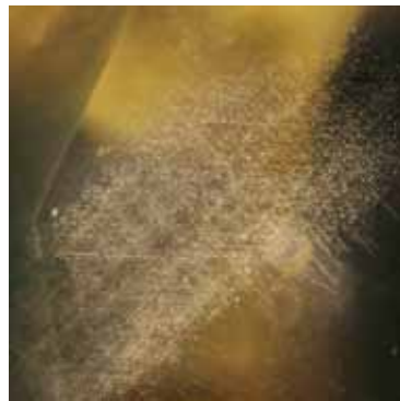
Рис. 3. Хмари точкових включень і голки у жовтому сапфірі, поле зору 4 мм Fig. 3. Clouds of point inclusions and needles in yellow sapphire, field of view 4 mm
