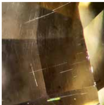
Рис. 4. Голчасті включення у жовтому сапфірі, поле зору 3 мм Fig. 4. Needle inclusions in yellow sapphire, field of view 3 mm
