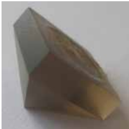
Рисунок 2. Вигляд каменя після обдирання з попередньо заданими пропорціями та розмірами майбутньої вставки (димчастий кварц)
