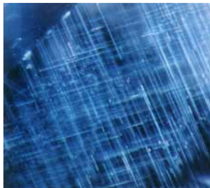
Рисунок 7. Включення рутилу до і після термообробки рубінів
