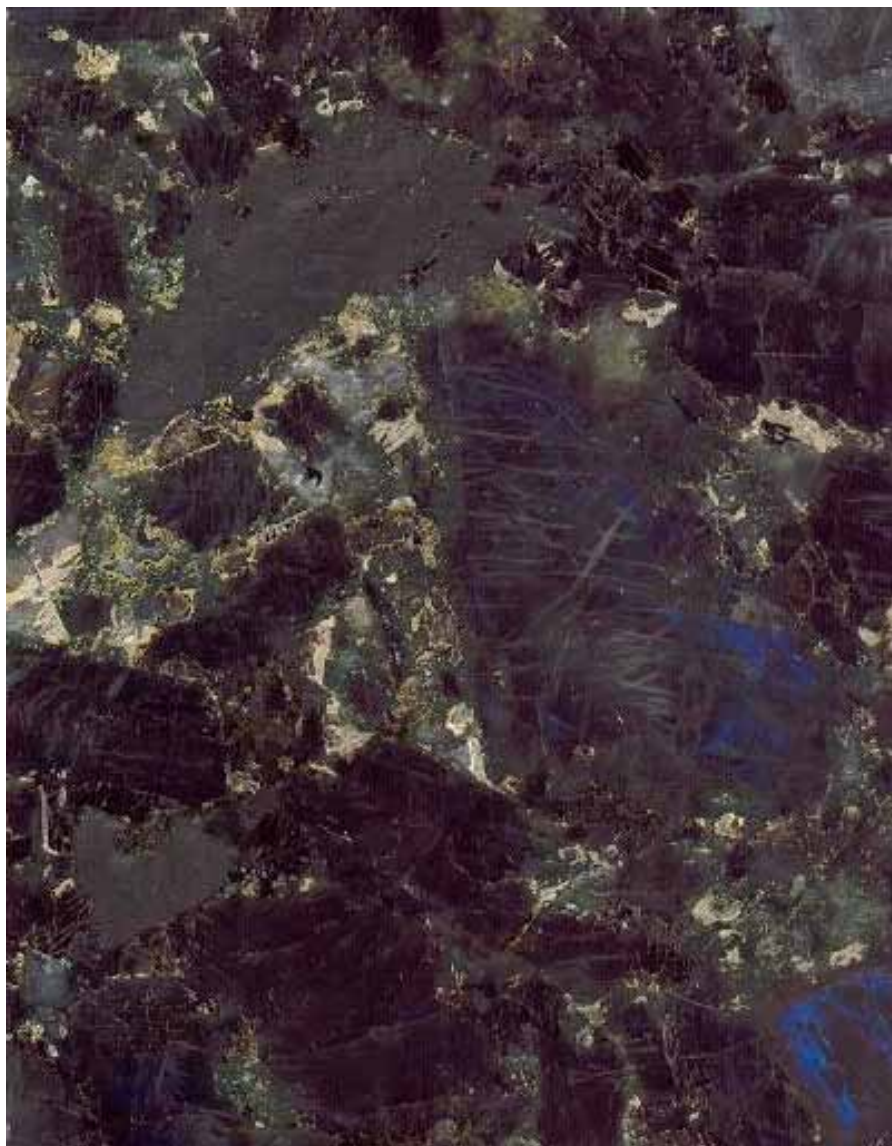
Рисунок 3. Зразок лабрадориту Верхолузького родовища після обробки парою азотної кислоти
