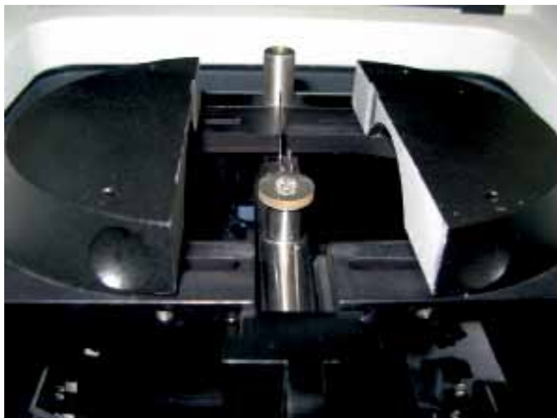
Рисунок 1. Приставка Collector II (на столику встановлено один з досліджуваних зразків) та схема проходження ІЧ-променя через досліджуваний зразок
