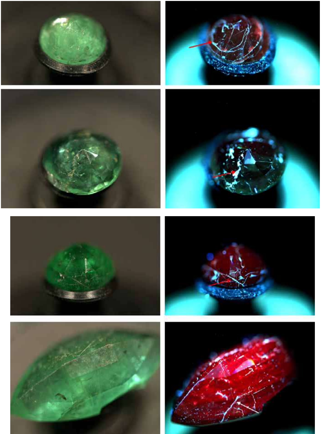
Рисунок 2. Люмінесценція смарагдів. Зображення отримано за допомогою приладу «DiamondView™». Зліва – зразки смарагдів у видимому світлі, праворуч – зразки в УФ-світлі. Речовини-заповнювачі під час УФ-випромінювання люмінесціюють білим кольором, також добре проявлена червона люмінесценція самих смарагдів
