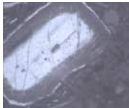
Рисунок 4. Фрагмент шліфа, тонкозональний плагіоклаз сублужного базальту. Шліф Ол-3. Зображення під поляризаційним мікроскопом з введеним аналізатором. Розмір зображення 2x1,5 мм (зліва), 0,8x0,6 мм (справа)
