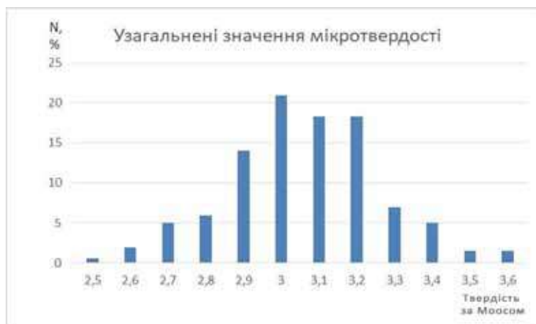
Рисунок 8. Гістограма розподілу абсолютних значень (1) та перерахованих за шкалою Мооса (2) масових вимірів мікротвердості в алебастрі
