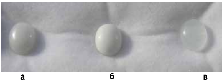
Фото 7. Жадеїт незмінений (а), відбілений (б), заповнений полімером (в)
