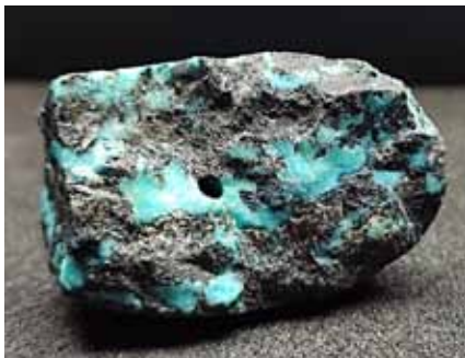
Рисунок 3. Композит з уламків бірюзи в полімерній матриці з крихтою природного каміння
