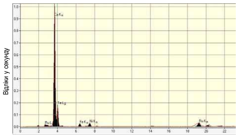
Рисунок 5. Композит на основі уламків карбонатного складу (імітація варисциту), який забарвлений сполуками Ні
