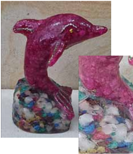
Рисунок 2. Композит з крихти синтетичного корунду, напівдорогоцінного каміння і синтетичної смоли
