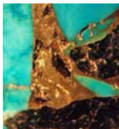
Рисунок 20. Композит – уламки карбонату в полімерній матриці з прожилками жовтого металу
