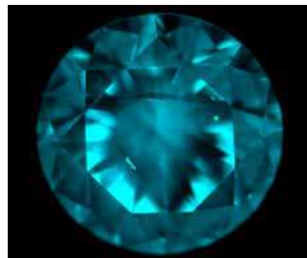
Фото 20. Безбарвний синтетичний алмаз. Вид з боку корони. Огранування – Кр-57, маса – 0,34 ct. Характерні металеві включення в синтетичному алмазі
