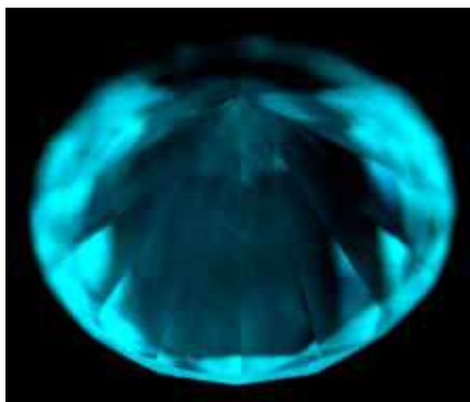
Фото 17, 18. Безбарвний синтетичний алмаз. Вид з боку павільйона. Огранування – Кр-57, маса – 0,52 ct
