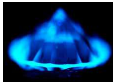
Фото 8. Природний алмаз. Огранування – Кр-57, маса – 0,35 ст. Спостерігаються нечіткі, але помітні і достатні для діагностики природні структури росту
