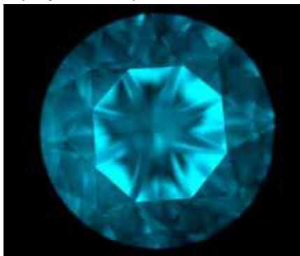
Фото 19. Безбарвний синтетичний алмаз. Вид з боку корони. Огранування – Кр-57, маса – 0,37 ct. Помітний кубічний сектор росту в центральній частині каменя
