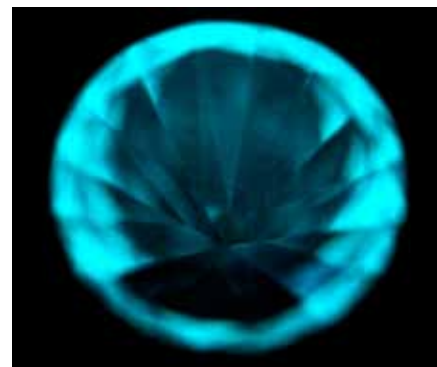
Фото 17, 18. Безбарвний синтетичний алмаз. Вид з боку павільйона. Огранування – Кр-57, маса – 0,52 ct
