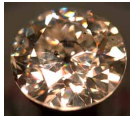
Фото 5. Природний алмаз. Огранування – Кр-57, маса – 0,50 ст. Вид з боку корони. На площадці чітко проявлені темні мінеральні включення
