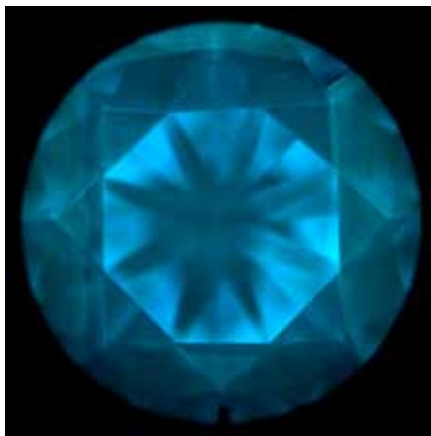
Фото 36. Блакитний синтетичний алмаз. Вид з боку павільйона. Огранування – Кр-57, маса – 0,43 ст. Структура росту за кубооктаедром займає більшу частину корони
