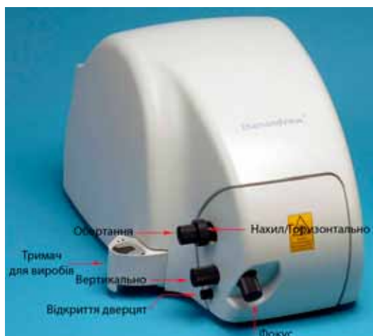
Фото 1. Зовнішній вигляд приладу "DiamondView™"
