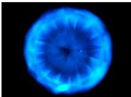
Фото 8. Природний алмаз. Огранування – Кр-57, маса – 0,35 ст. Спостерігаються нечіткі, але помітні і достатні для діагностики природні структури росту
