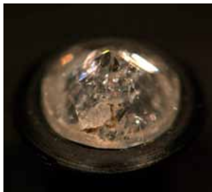
Фото 4. Природний алмаз. Огранування – Кр-57, маса – 0,11 ст. Вид з боку павільйона. Добре помітно велику тріщину та мінеральні включення
