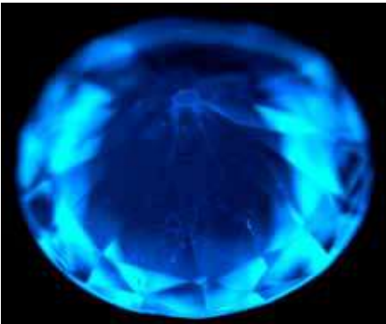
Фото 11. Природний алмаз. Огранування – Кр-57, маса – 0,50 ст. Помітні фігури росту у вигляді полігональної сітки
