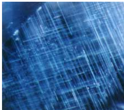
Рисунок 7. Включення рутилу до і після термообробки рубінів
