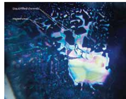
Рисунок 6. Залікована тріщина в сапфірі. Структура заліковування співвідноситься зі структурою кристала, розташування залікованих областей повторює кристалографічну структуру сапфіра (у цьому випадку під кутами 60/120°)
