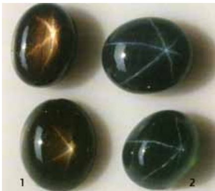
Рисунок 10. Ефект астеризму ("зірки") в корунді природному (1) та термообробленому (2)
