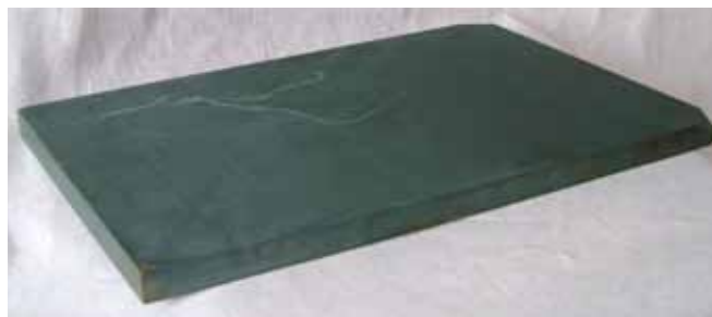
Рисунок 1. Плита з яшми технічної для притирання оптичних деталей з середньою шорсткістю Ra = 0,015\text{ мкм}
