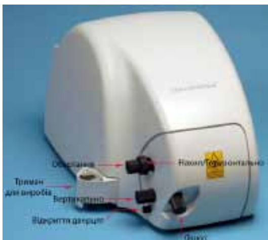
Рисунок 8. Зовнішній вигляд приладу «Diamond View» та його внутрішня будова
