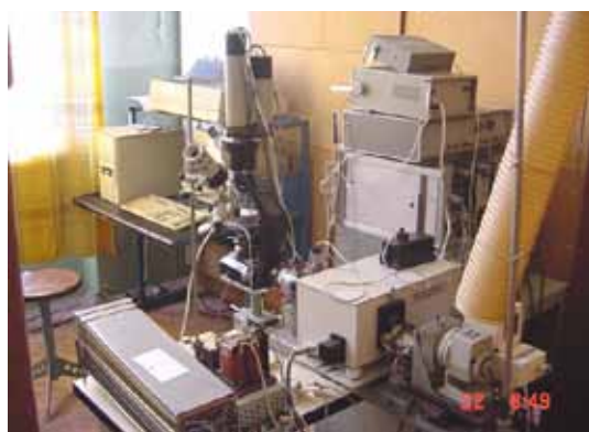
Рисунок 17. Мікроспектрофотометрична установка, створена на базі оптичного монохроматора «SpectraPro-275»
