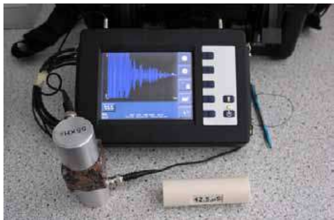
Рисунок 1. Общий вид ультразвукового дефектоскопа модели C372N итальянской фирмы «MATEST»
