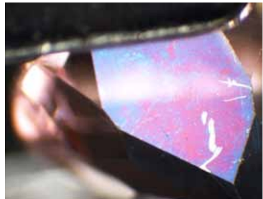
Рисунок 2. Райдужна поверхня плівки та подряпини на гранях топазу. Збільшення x16
