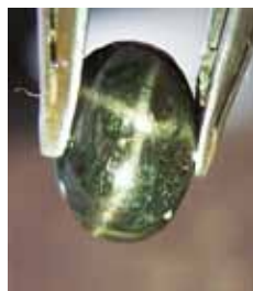
Рисунок 1. Ефект астеризму в чорному діоксиді (зразок Ру17/ Ук-41)
