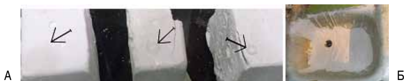
Рисунок 1. А) Пример смачивания образцов, слева направо: сильно смачиваемый (водосорбирующий, 1), слабо смачиваемый (2) и несмачиваемый (3).
