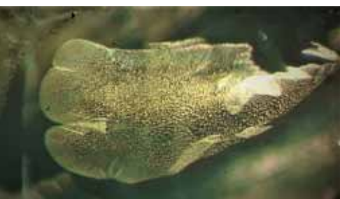
Рисунок 11. Флюсові включення (вуалі) в смарагдах синтетичних, зб. 50
