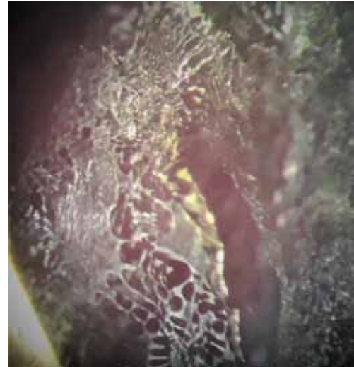
Рисунок 12. Флюсові включення (вуалі) в олександриті синтетичному, зб. 36
