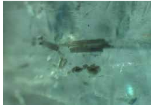
Рисунок 3. Протогенетичні включення слюди в смарагді, зб. 46
