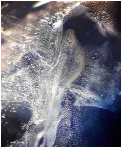
Рисунок 6. Флюсоподібний штучний заповнювач у тріщинах у сапфірі синьому, зб. 120
